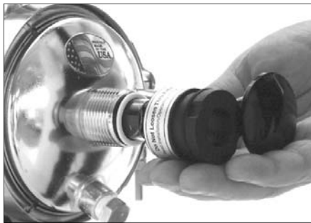
Step 4 - Remove Gland Nuts
