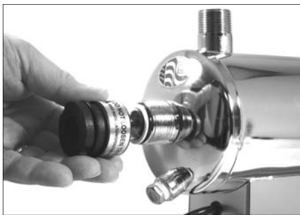
Step 4 - Remove Gland Nuts
